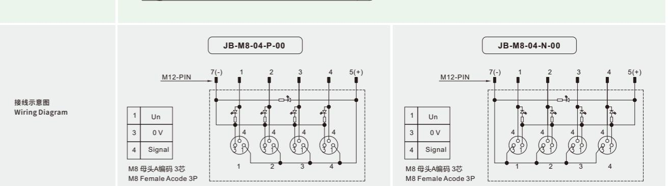
JB系列分线盒 (M8接口6路端口-M12连接器式出线型) JB Series Junction Box CE RoHS
