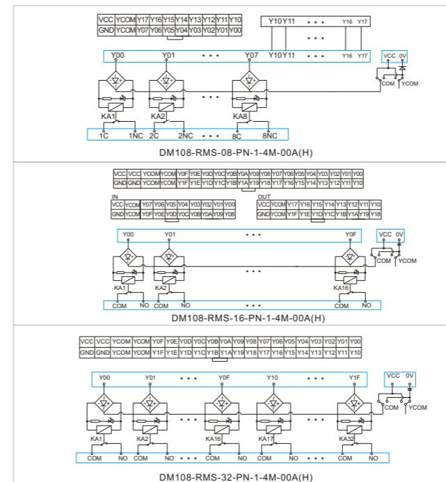
**接线方式 Wiring Method**
