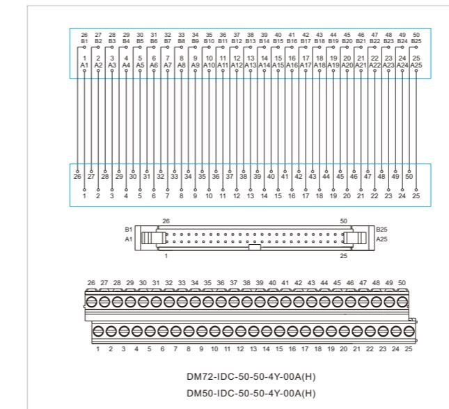
20位IDC接口模组 20P IDC Interface Module
