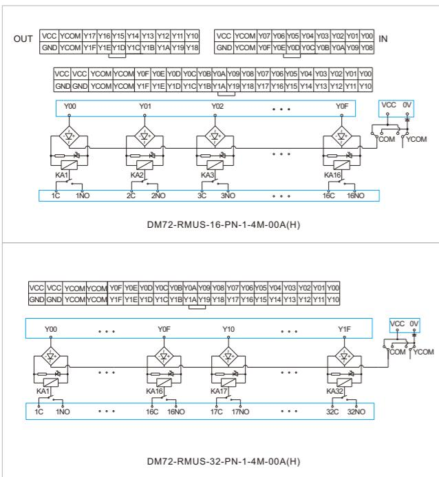
**接线方式 Wiring Method**
