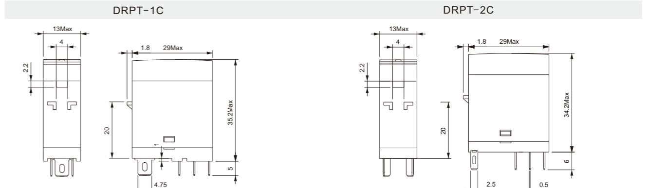
**脚位图、接线图 Installation Diagrams, Wiring Diagrams**
