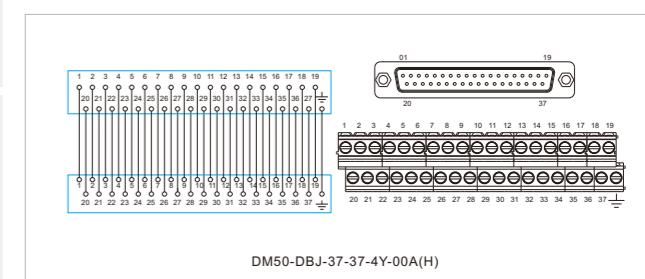
**电路图 Circuit Diagram**
